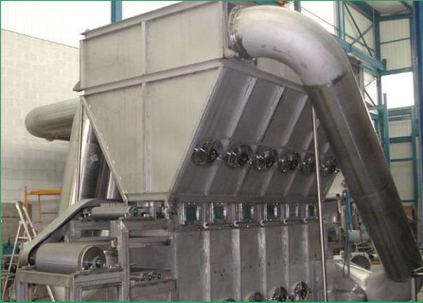
**SECADERO DE LECHO FLUIDO:** Es un tipo de secadero directo que consta de una cámara dónde se introduce el producto a secar y se hace circular el aire por la parte inferior. El aire se introduce con suficiente fuerza como para sustentar el producto y expansionarlo. De esta manera se consigue una mezcla vigorosa del producto, por lo que el secado es muy rápido y homogéneo. Además se reducen las partes móviles, lo que evita posibles contaminaciones y reduce el mantenimiento.
