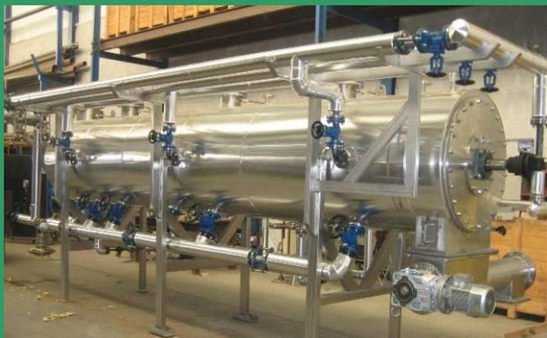
**SECADERO DE TURBINA RADIANTE (STR):** Este equipo también de construcción cilíndrica difiere en que no es el cuerpo el que gira, sino que existen unas palas o turbina en el interior que voltean y hacen avanzar el producto sometándolo a esfuerzos de cizalladura que evitan su apelmazamiento. El calor se transmite de manera indirecta por la turbina y el cuerpo del secadero. Su uso está indicado cuando el producto a secar tiende a apelmazarse.
