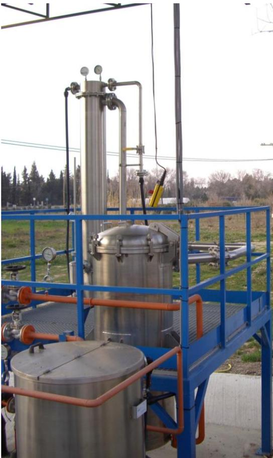
Si la carga se realiza por transporte neumático el alambique se carga por la parte superior de manera automática y una vez finalizada la extracción se procede a la descarga abriendo la tapa inferior del alambique, que descarga sobre un foso, vagoneta o cinta transportadora.
